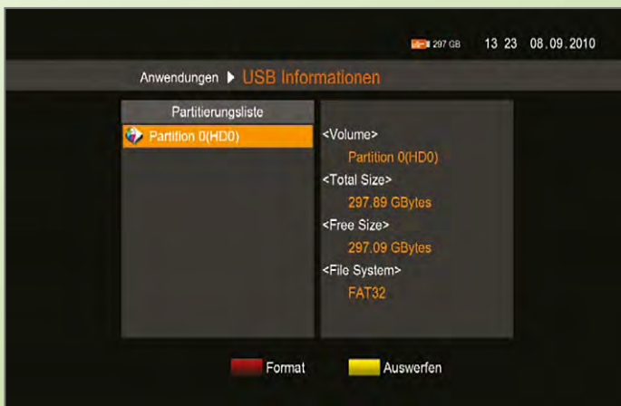
Formatieren einer über USB 2.0 angeschlossenen Festplatte |
